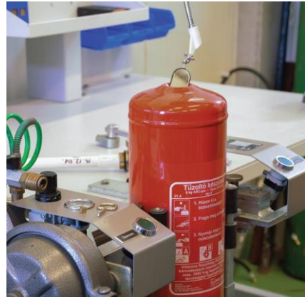
Tartály ellenőrzése tükrös tartályvizsgálóval
