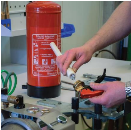
Felszállócső és nyomórugó kiemelése
