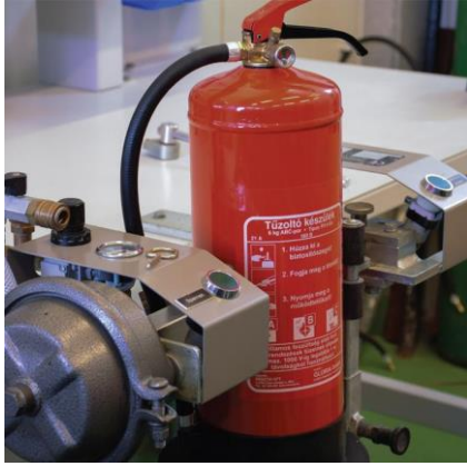
Készülék stabil rögzítése készülékbefogóval
