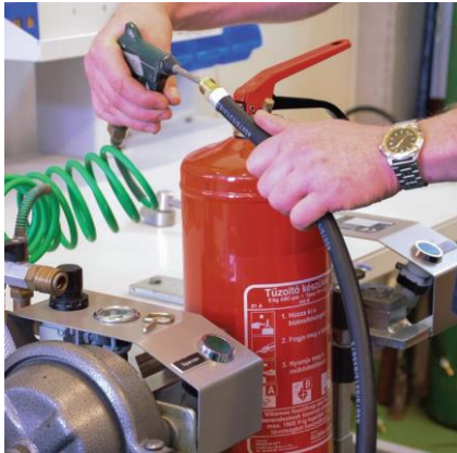
Tömlőszerelvény vizsgálata, kifűtatása sűrített levegővel
