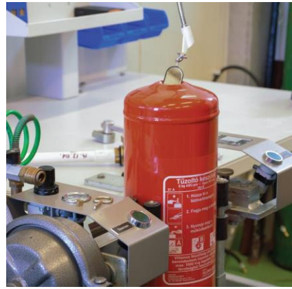
Tartály ellenőrzése tükrös tartályvizsgálóval
