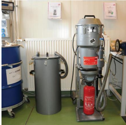
Porvisszatöltés zártrendszerű berendezéssel
