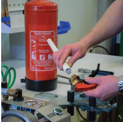
Felszállócső és nyomórugó kiemelése
