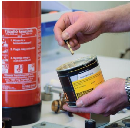
Szelepszár zsírozása, fejszerelvény összeszerelése
