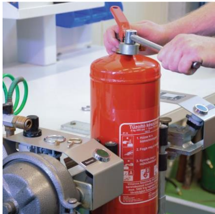
Fejszerelvény kitekerése CSAK NYOMÁSMENTES ÁLLAPOTBAN!
