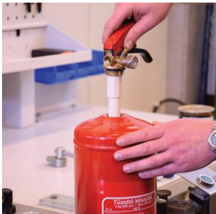
Komplett fejszerelvény függőleges behelyezése a tartályba
