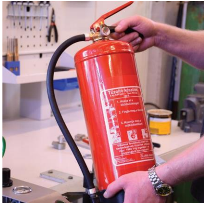
Karbantartott készülék végső szemrevételezése
