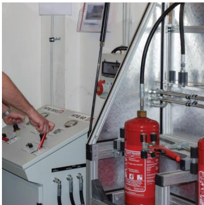
Tartályok nyomáspróbázása (a palástba beütött érték szerint)
