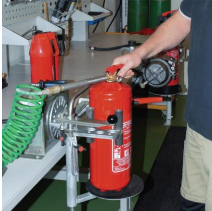
A készüléket nitrogénnel nyomás alá helyezzük
