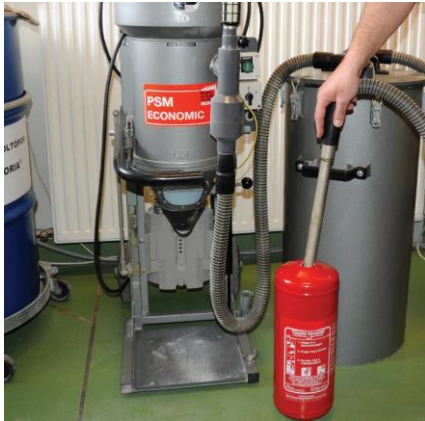
Porkiszívás zártrendszerű berendezéssel
