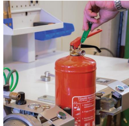
Készülék nyomásmentesítése a szelepbetét eltávolításával
