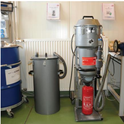
Porvisszatöltés zártrendszerű berendezéssel
