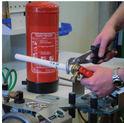
Felszállócső kitekerése a fejszerelvényből
