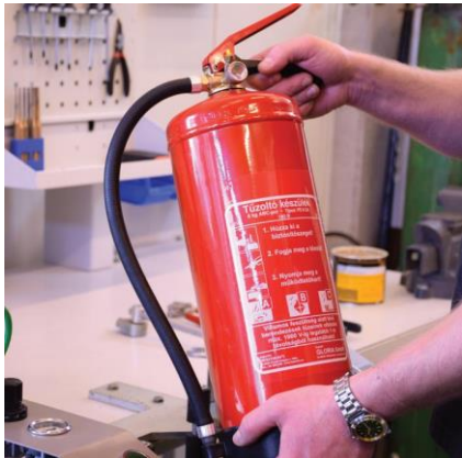
Karbantartott készülék végső szemrevételezése
