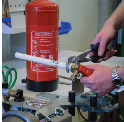
Felszállócső kitekerése a fejszerelvényből
